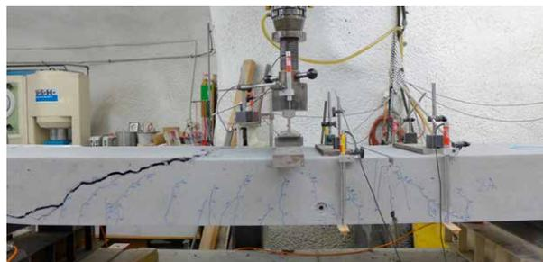
Die hohe Querkraftübertragung von 85 % wurde versuchstechnisch nachgewiesen.
