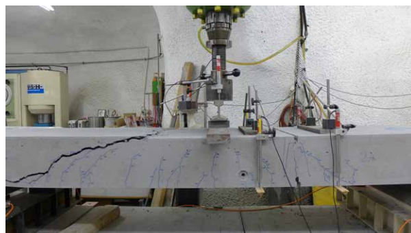
Des essais ont prouvés la haute transmission des efforts de cisaillement de 85 %.
